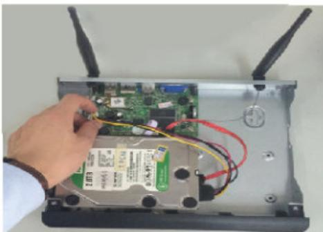
3. Держа жесткий диск и NVR, аккуратно переверните его и совместите отверстия на жестком диске с отверстиями на корпусе NVR. Используя крестовую отвертку, вверните прилагаемые винты в отверстия и установите крышку назад.
