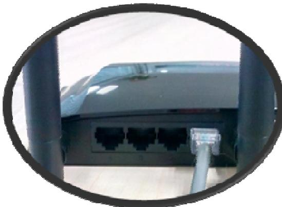
3. Подключите компьютер к порту LAN роутера с помощью кабеля Ethernet.
